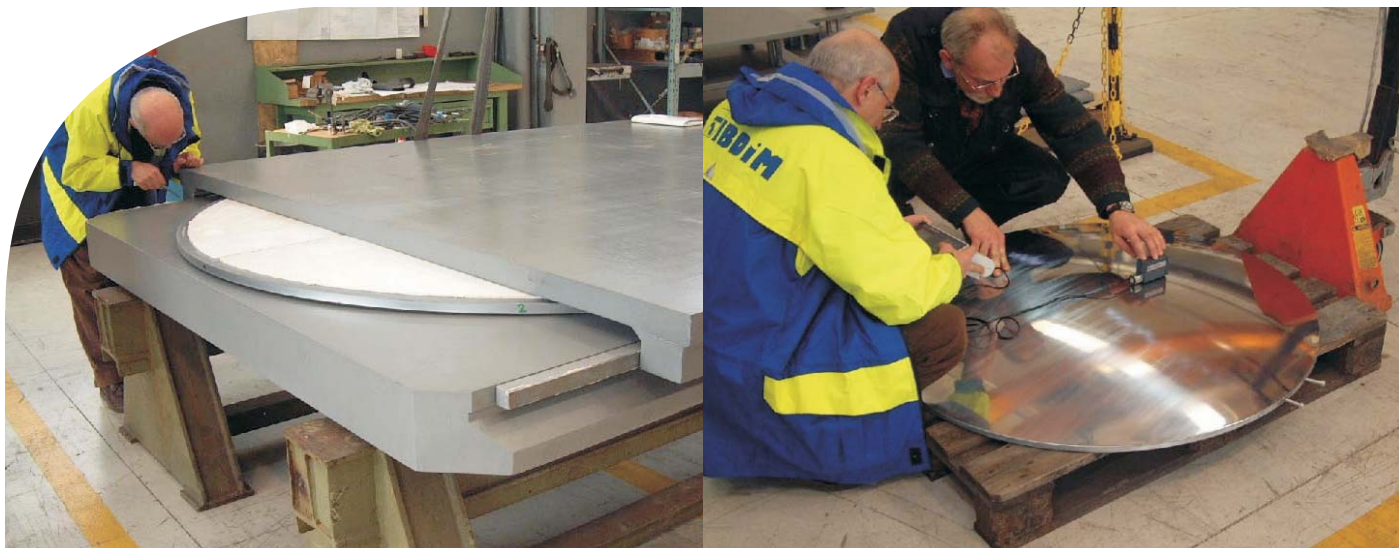
Kontrola kvaliteta SFERON ležišta kapaciteta 110.000 kN izrađenih za most Plok u Varšavi. Proveru sproveo dr Njemierko iz Instituta IBDIM iz Varšave.
