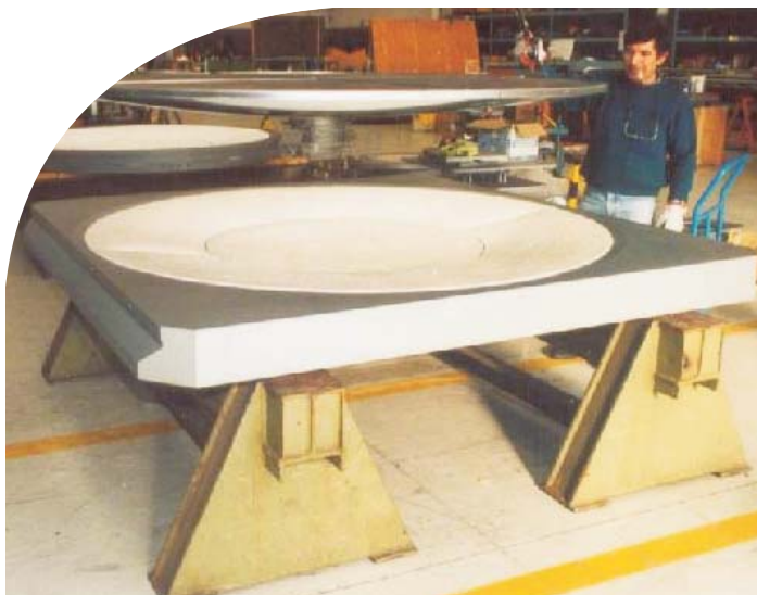
Proizvodnja SFERON ležišta kapaciteta 110.000 kN za most Plok u Varšavi Fabrication of 110.000 kN capacity SFERON bearings for the Plok Bridge in Warsaw.
